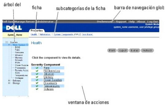
Ilustración 5-1. Ejemplo de la página de inicio de Server Administrator: sistema no modular
